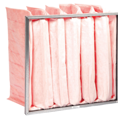
FILTRE A POCHE SOUPLES / RIGIDES MÉDIA FIBRE DE VERRE / SYNTHÉTIQUE CADRE GALVA / PLASTIQUE
